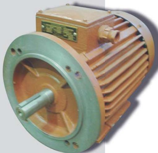
Электродвигатели с повышенным скольжением АИРС160, АИРС200, АИРС225 и АИРС250 предназначены для привода механизмов с высоким коэффициентом инерции, механизмов с неравномерной пульсирующей нагрузкой и механизмов с частыми и тяжёлыми пусками.
