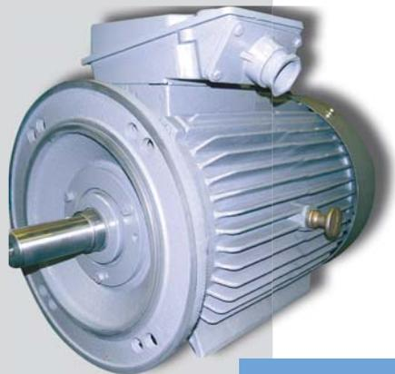
Трёхфазные асинхронные двигатели с короткозамкнутым ротором в специальном исполнении А112М4ЖНДУ5, А160S2ЖНДУ5, А225М2ЖНДУ4, А250S2ЖНДУ5, А250М-2ЖНДУ4, А355М4ЖНДУ4-1 предназначены для привода центробежных многоступенчатых секционных электронасосных агрегатов специального назначения. Питание двигателей осуществляется от сети трёхфазного переменного тока напряжением 380 В, частотой 50 Гц. Режим работы двигателей – продолжительный.
