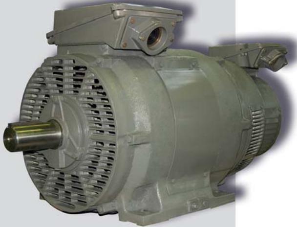
Двигатели 5АНК225, 5АНК250 с фазным ротором предназначены для продолжительного режима работы S1 по ГОСТ 183 от сети переменного тока частоты 50 Гц напряжением 380 В в приводах с тяжёлыми условиями пуска.
