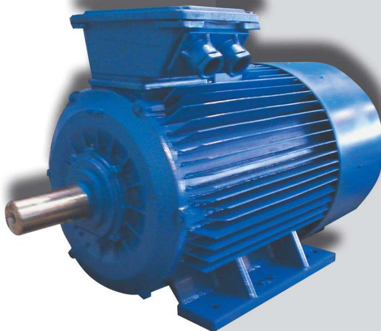
Двигатели имеют систему изоляции класса нагревостойкости «Н», встроенные для контроля температуры подшипников платиновые термопреобразователи температуры ТС034–100 П с линейной характеристикой зависимости сопротивления, датчики температурной защиты обмотки.
