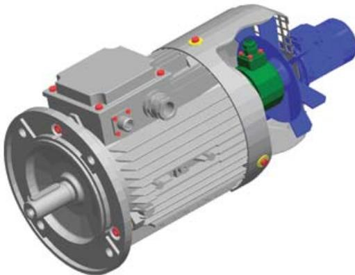
Частотно-регулируемый асинхронный двигатель модификации «ДВ». Компоновка: пристроенный датчик частоты вращения и независимая система вентиляции с вентилятором-наездником.
