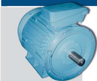
Трёхфазные асинхронные двигатели с короткозамкнутым ротором типа А-ВС предназначены для привода специальных вентиляторов. Питание двигателей осуществляется от сети трехфазного переменного тока напряжением 380 В, частотой 50 Гц. Режим работы двигателей – продолжительный.
