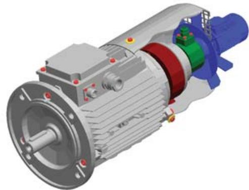
Частотно-регулируемый асинхронный двигатель модификации «ТДВ». Компоновка: пристроенные электромагнитный тормоз и датчик частоты вращения, независимая система вентиляции с вентилятором-наездником.
