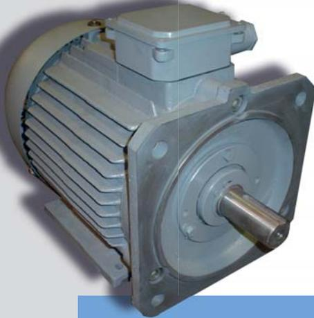
Трёхфазный асинхронный двухскоростной двигатель с короткозамкнутым ротором мощностью 5,5/11,0 кВт и синхронной частотой вращения 3000/6000 об/мин предназначен для привода специального изделия.
