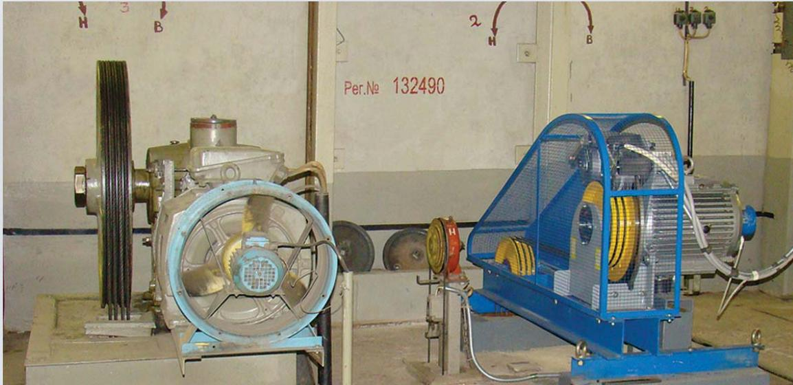
Редукторная лебёдка с двухскоростным двигателем и
