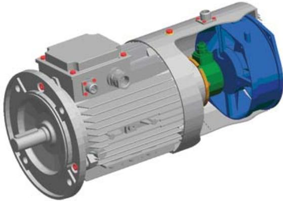
Частотно-регулируемый асинхронный двигатель модификации «ДВ». Компоновка: пристроенный датчик частоты вращения и независимая система вентиляции со встроенным вентилятором.
