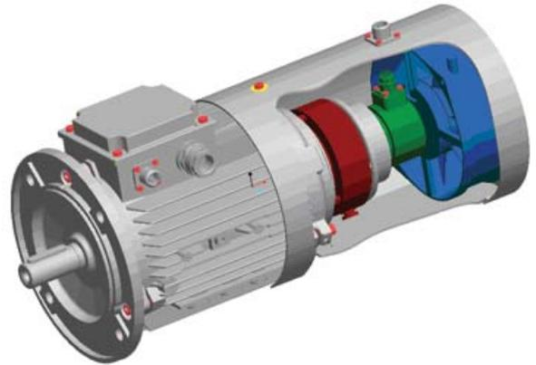
Частотно-регулируемый асинхронный двигатель модификации «ТДВ». Компоновка: пристроенные электромагнитный тормоз и датчик частоты вращения, независимая система вентиляции со встроенным вентилятором.
