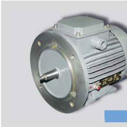
Трёхфазный асинхронный двигатель с короткозамкнутым ротором мощностью 0,75 кВт предназначен для привода центробежных вентиляторов электровозов. Питание двигателя – от преобразователя частоты с широтно-импульсной модуляцией напряжением 380 В и частотой 50 Гц. Режим работы двигателей – продолжительный. Двигатели соответствуют условиям эксплуатации в части воздействия механических факторов группе М25 по ГОСТ 17516.1. Ресурс двигателя до капитального ремонта – 72000 ч, срок службы – 33 года.
